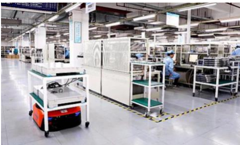
Abbildung 10 – Materialanlieferung zur Produktion mit Quicktron Robotern
