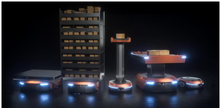
Abbildung 2 – Quicktron Roboter für den innerbetrieblichen Transport
